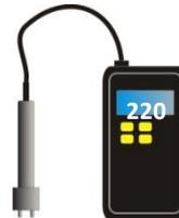
NOTE: Una sbagliata impostazione della temperatura del termoelemento può comportare un cattivo esito della saldatura. Verificare periodicamente con un termometro digitale tarato che la temperatura delle superfici del termoelemento sia corretta.
